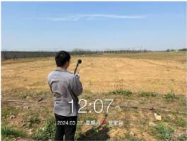
南侧厂界外 1m 处 N2△2-昼间
