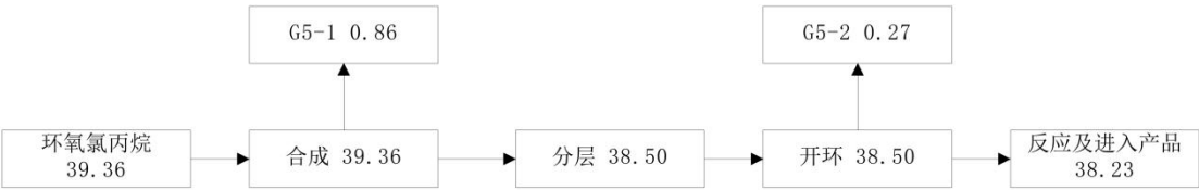
图 3.2.5-4 POPDH 工艺全年环氧氯丙烷平衡图 (t/a)
