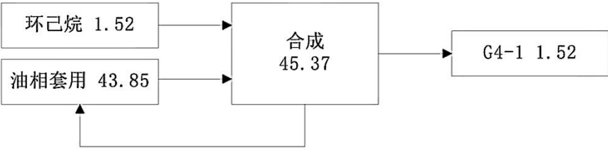
图 3.2.4-4 POPS 工艺全年环己烷平衡图 (t/a)
